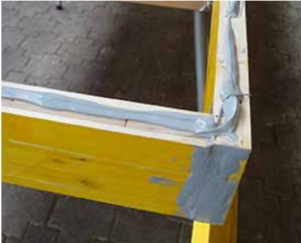
4. Appliquer de la colle sur le dessous du cadre avant le montage du fond.
